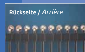
Lötpunkte mit herkömmlichem Lot Points de soudure avec brasage traditionnel
