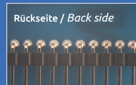
Lötpunkte mit SR-HS Solder points with SR-HS
