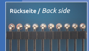
Lötpunkte mit herkömmlichem Lot Solder points with standard solder
