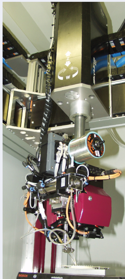
Figure 7: Le module de brasage laser est positionné au dessus du point de brasage sur une potence à quatre axes numériques pilotés par des servomoteurs.
